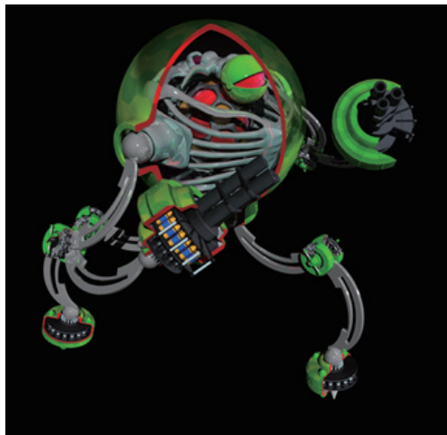
内部構造図。 肘と膝の関節は全て同じ構造。 本体の骨格はコアを包んでいる。
